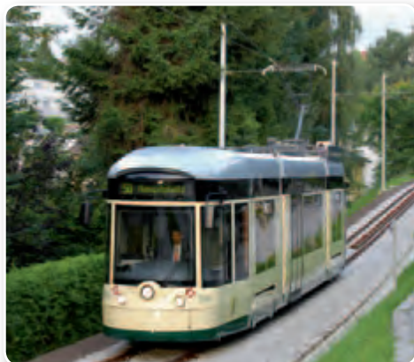
Die Linzer Pöstlingbergbahn ist technisch keine Zahnradbahn, sondern eine der steilsten Adhäsionsbahnen, die den Charakter und die Funktion einer Bergbahn hat.
